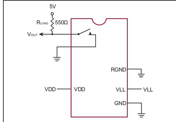
**FIGURE 3-4:**  $T_{ON}/T_{OFF}$  Test Circuit.
