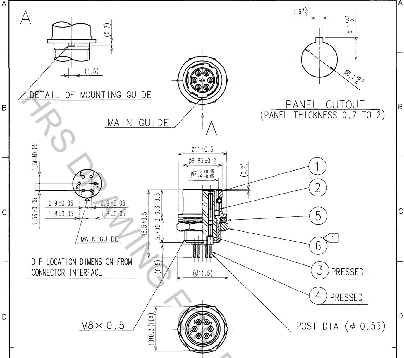
NOTE: ① THE RECOMMENDED CLAMP TORQUE OF REF.NO.⑥: 1.5N·m
