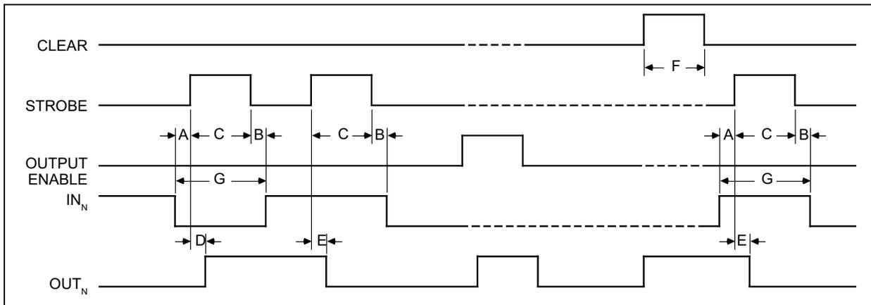
**FIGURE 3-1:** Timing Diagram.
