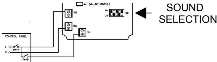
FIGURE 4: SYSTEM CONNECTION
